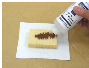
ワックスの上に、リキッドサンドペーパーJをたっぷりと塗布。
