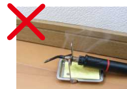
作業中、着火したまま煙が出るような状態で放置していませんか？
