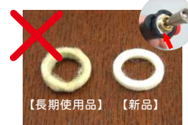
長時間使用すると、フィルターがこんなにも汚れます。早めの交換をお勧めします。
